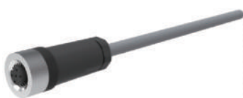
接插件和电缆 型号：9305-4B2/X-18.006 A头：插座，M12，5针，顺时针，直头，A编码 B头：裸线端，×米电缆，PVC，独立单芯线5×0.2mm 2 ，Φ5.8
