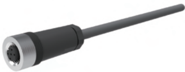
接插件和电缆 型号：9212B/X-18.006 A头：插座，M12，5针，逆时针，直头 B头：裸线端，X米电缆，RVVP，屏蔽电缆独立芯线5×0.2mm 2 ，Ø5.8
