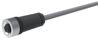
接插件和电缆 型号: 9305-4B2/X-18.006 A头: 插座, M12, 5针, 顺时针, 直头, A编码 B头: 裸线端, ×米电缆, PVC, 独立单芯线5×0.2mm 2 , Ø5.8
