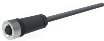
接插件和电缆 型号：9212-1B/X-18.015 A头：插座，M12，8针，顺时针，直头 B头：裸线端，X米电缆，RVVP，双绞屏蔽线 4 \times 2 \times 0.2\text{mm}^2 ， \varnothing 6.8
