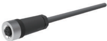
接插件和电缆 型号：9212B/X-18.006 A头：插座，M12，5针，顺时针，直头 B头：裸线端，X米电缆，RVVP，屏蔽电缆独立芯线 5 \times 0.2\text{mm}^2 ， \varnothing 5.8
