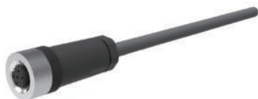
接插件和电缆 型号：9212B/X-18.006 A头：插座，M12，5针，顺时针，直头 B头：裸线端，X米电缆，RVVP，屏蔽独立芯线 5 \times 0.2\text{mm}^2 ， \varnothing 5.8
