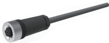
接插件和电缆 型号：9212-1B/X-18.015 A头：插座，M12，8针，顺时针，直头 B头：裸线端，X米电缆，RVVP，双绞屏蔽线 4 \times 2 \times 0.2\text{mm}^2 ， \varnothing 6.8
