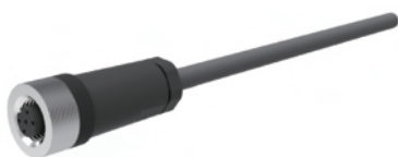
接插件和电缆 型号：9212B/X-18.006 A头：插座，M12，5针，A编码，直头 B头：裸线端，X米电缆，RVVP，屏蔽电缆独立芯线 5 \times 0.2 \text{mm}^2 ， \varnothing 5.8
