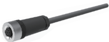
接插件和电缆 型号：9212-1B/X-18.015 A头：插座，M12，8针，A编码，直头 B头：裸线端，X米电缆，RVVP，双绞屏蔽线 4 \times 2 \times 0.2 \text{mm}^2 ， \varnothing 6.8
