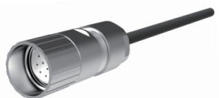
接插件和电缆（适用于SSI接口+增量信号） 型号：9223B/X-22.001 A头：插座，M23，12针，顺时针，直头 B头：裸线端，X米电缆，RVVP，带屏蔽线 6 \times 2 \times 0.142 \text{mm}^2 ， \Phi 6.8
