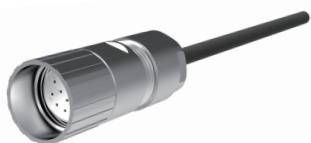
接插件和电缆（适用于SSI接口） 型号：9223B/X-18.015 A头：插座，M23，12针，逆时针，直头 B头：裸线端，X米电缆，RVVP，带屏蔽线 4 \times 2 \times 0.2 \text{mm}^2 ， \Phi 6.8
