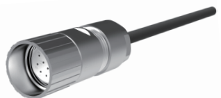
接插件和电缆（适用于SSI接口+增量信号） 型号：9223B/X-22.001 A头：插座，M23，12针，逆时针，直头 B头：裸线端，X米电缆，RVVP，带屏蔽线 6 \times 2 \times 0.142 \text{mm}^2 ， \Phi 6.8
