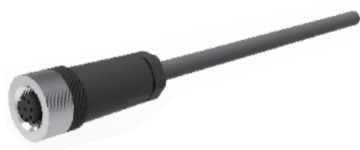
接插件和电缆 型号：9212-1B/X-18.015 A头：插座，M12，8针，A编码，直头 B头：裸线端，X米电缆，RVVP，双绞屏蔽线 4 \times 2 \times 0.2\text{mm}^2 ， \phi 6.8
