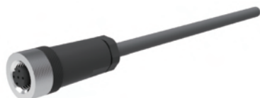
接插件和电缆 型号：9212B/X-18.006 A头：插座，M12，5针，A编码，直头 B头：裸线端，X米电缆，RVVP，屏蔽电缆独立芯线 5 \times 0.2\text{mm}^2 ， \phi 5.8
