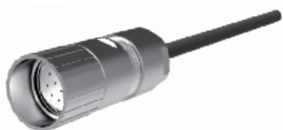
接插件和电缆（适用于SSI接口） 型号：9223B/X-18.015 A头：插座，M23，12针，顺时针，直头 B头：裸线端，X米电缆，RVVP，带屏蔽线 4 \times 2 \times 0.2 \text{mm}^2 ， \Phi 6.8
