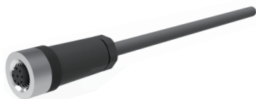
接插件和电缆 型号：9212-1B/X-18.015 A头：插座，M12，8针，逆时针，直头 B头：裸线端，X米电缆，RVVP，双绞屏蔽线 4 \times 2 \times 0.2 \text{mm}^2 ， \varnothing 6.8
