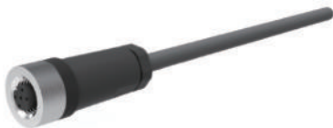
接插件和电缆 型号：9212B/X-18.006 A头：插座，M12，5针，逆时针，直头 B头：裸线端，X米电缆，RVVP，屏蔽电缆独立芯线 5 \times 0.2 \text{mm}^2 ， \varnothing 5.8
