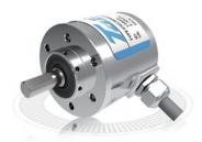
ESIC38S系列 感应原理 光电 外径 Φ38mm 实心轴 Φ6mm 最大脉冲 5000PPR 工作电压 5V,9-26V,5-30V 防护等级 IP54、IP65
