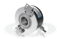
ESG90H 系列 感应原理 光电 外径 Φ90mm 轴径 Φ20、Φ25、Φ30mm 最大脉冲5000PPR 工作电压5VDC, 5-30VDC, 9-26VDC 防护等级IP54/IP65
