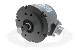
EHK68S 系列 感应原理 光电 外径 Φ68mm 实心轴 Φ6、Φ8、Φ10mm 最大脉冲1200PPR 工作电压5VDC, 5-30VDC, 9-26VDC 防护等级IP65/IP67
